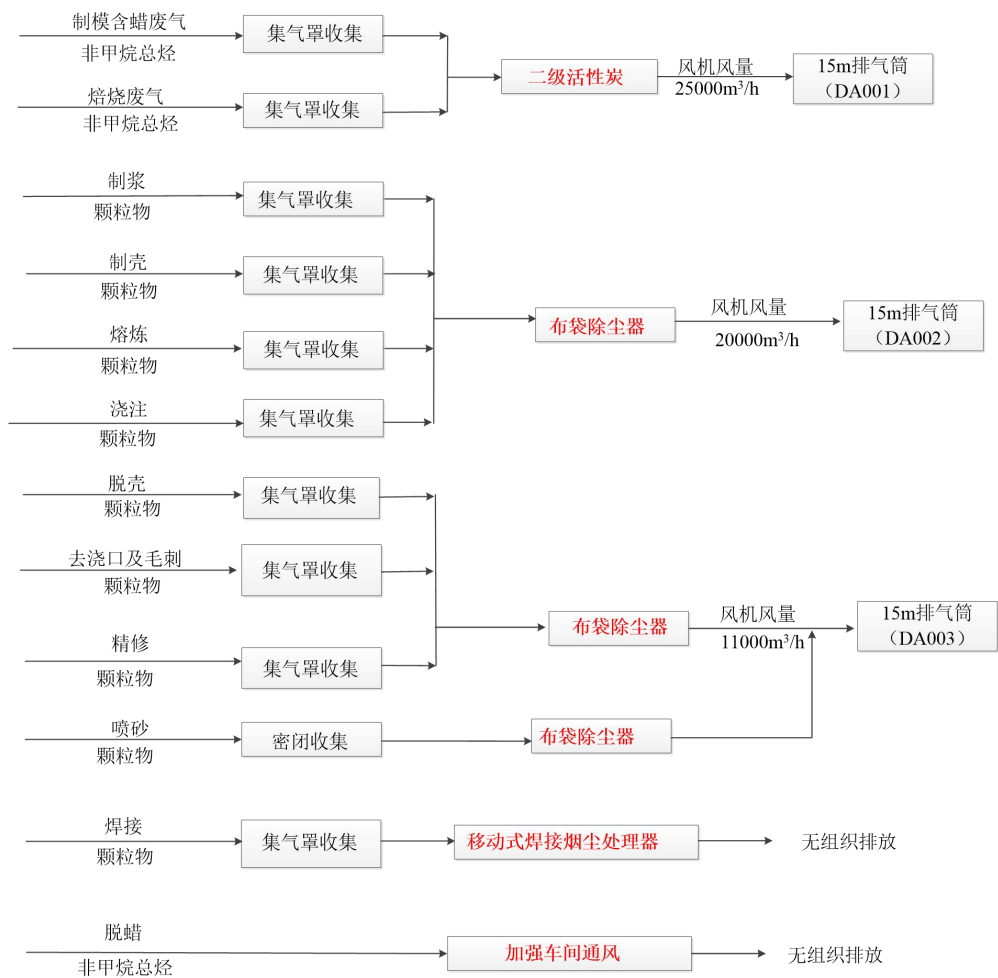
图 4-1 废气收集治理工艺流程图
