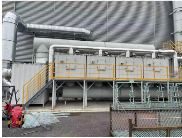
喷漆房两级活性炭吸附+催化氧化装置
