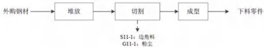
图 2-4 下料工艺流程及产污环节图
