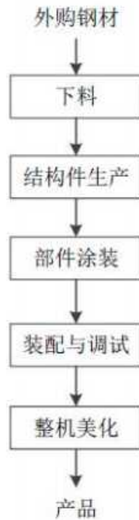
图 2-3 高空作业平台项目工艺流程图
