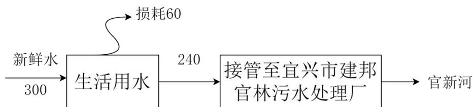
图 2.1-1 项目水平衡图（单位：m<sup>3</sup>/a）
