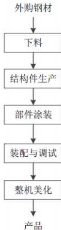
图 2-3 高空作业平台项目工艺流程图
