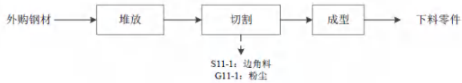
图 2-4 下料工艺流程及产污环节图
