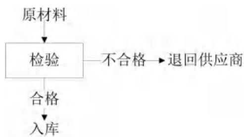
图6 工艺及产污流程
