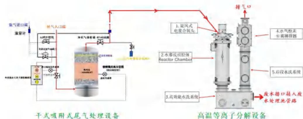
图 4-1 Scrubber（干式净化设备+等离子体高温分解水洗设备）设备系统
