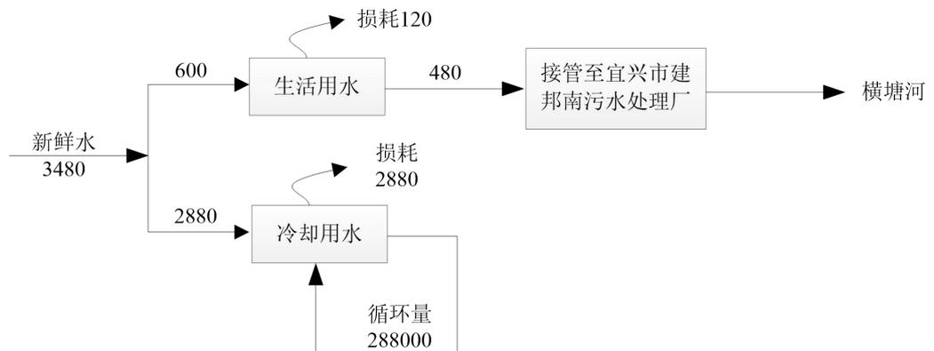
图 2.1-1 项目水平衡图（单位：m<sup>3</sup>/a）
