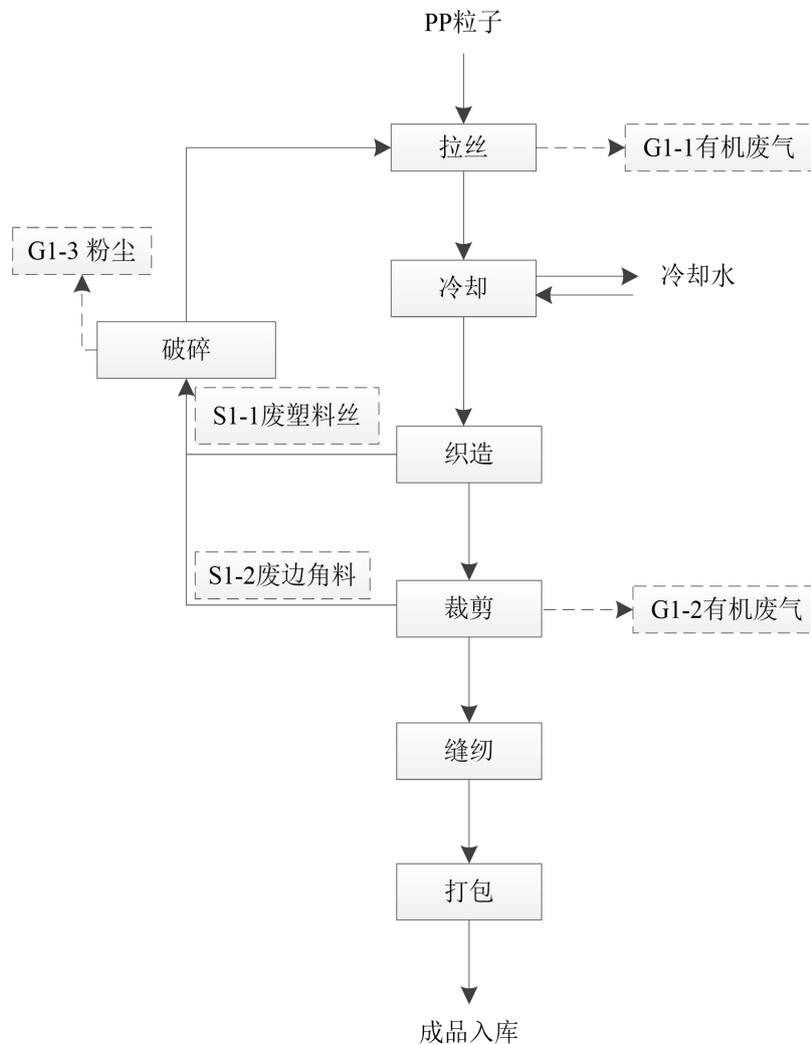
图 2.2-1 项目集装袋生产工艺流程图
