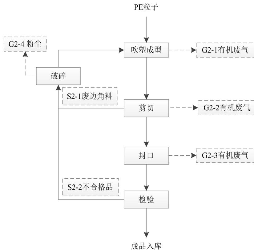
图 2.2-2 项目塑料袋生产工艺流程图
