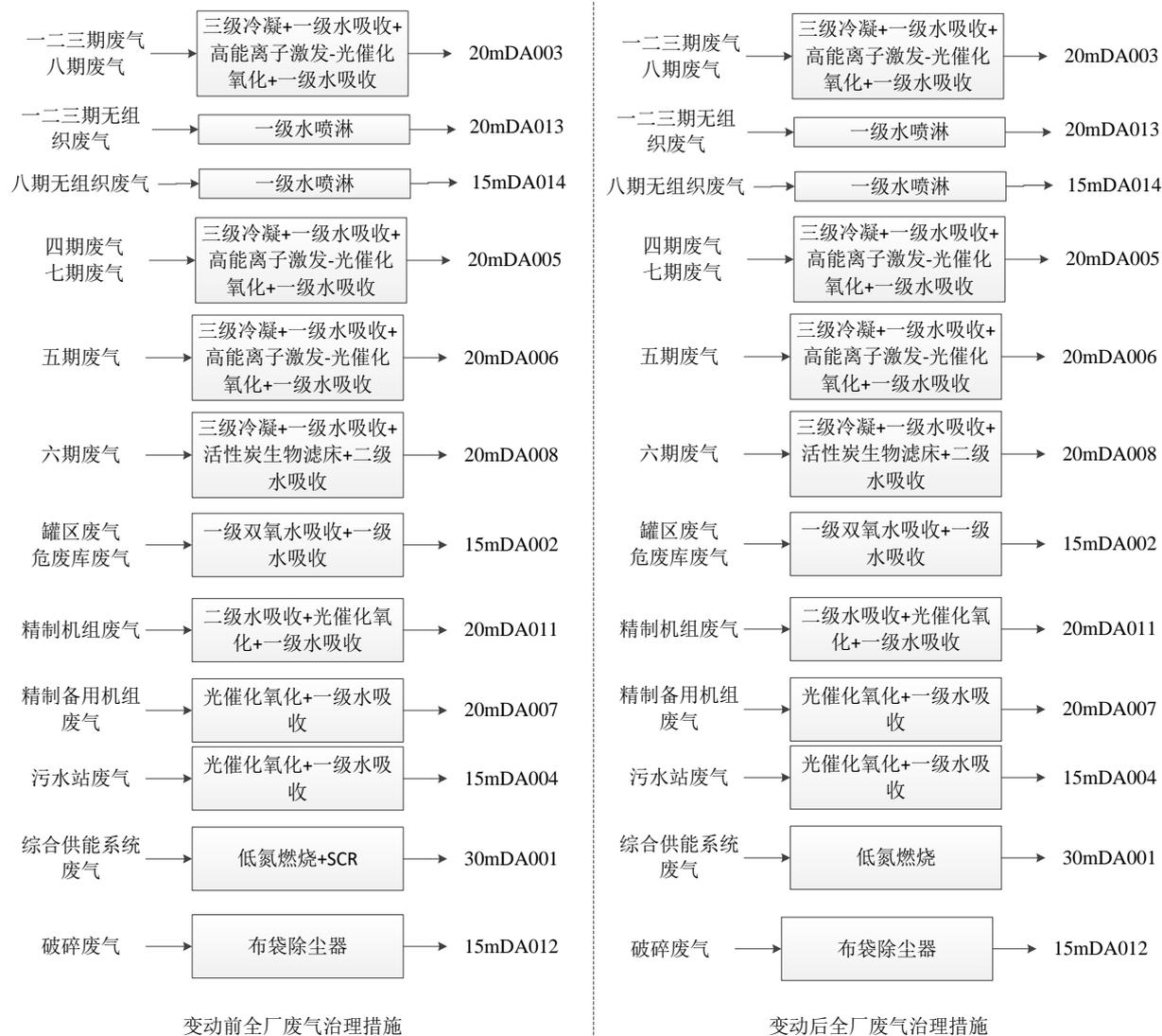
图 2.5-1 验收后企业全厂废气防治措施变动前后对比情况示意图
