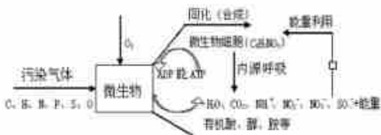
图 6.2-1 生物滤池法除臭工艺原理
